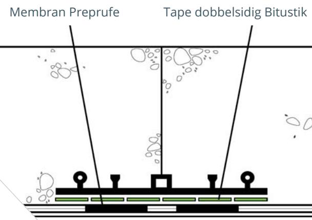
Illustrasjonen viser et eksempel på bruk av Tape dobbelsidig Bitustik Std, mellom membran og fugebånd.
